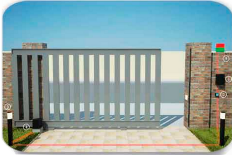
1 - Tablero 2- Botonera 3- Fotoeléctrica 4- Motorreductor 5- Semáforo
