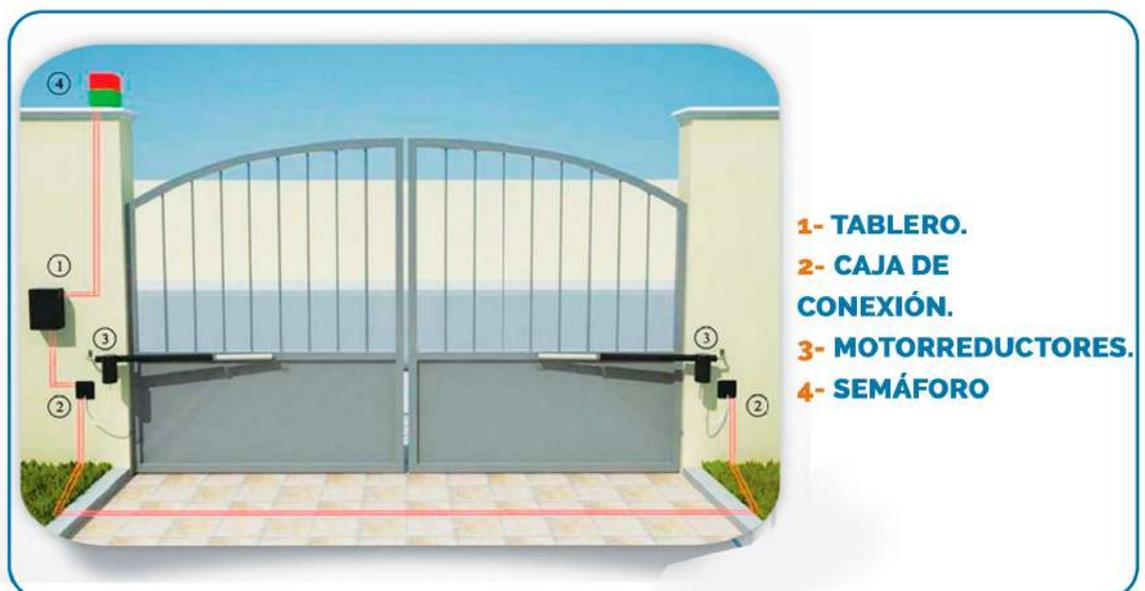
Para el diagrama básico, dejar la alimentación en el tablero y conectar tuberías que lo unan con las cajas de conexión de motores.
